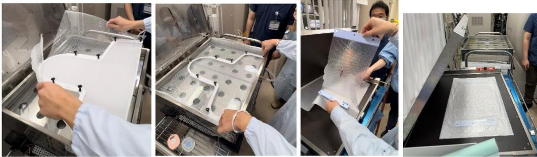
▲模具未加熱為白色 ▲加熱變透明 ▲模具加熱後 ▲不同加熱方式
